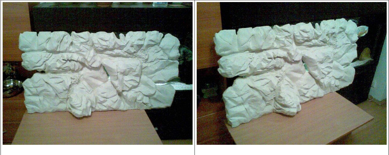
Imagini dupa aplicarea unui strat amorsa si a unui strat gros de ciment.
